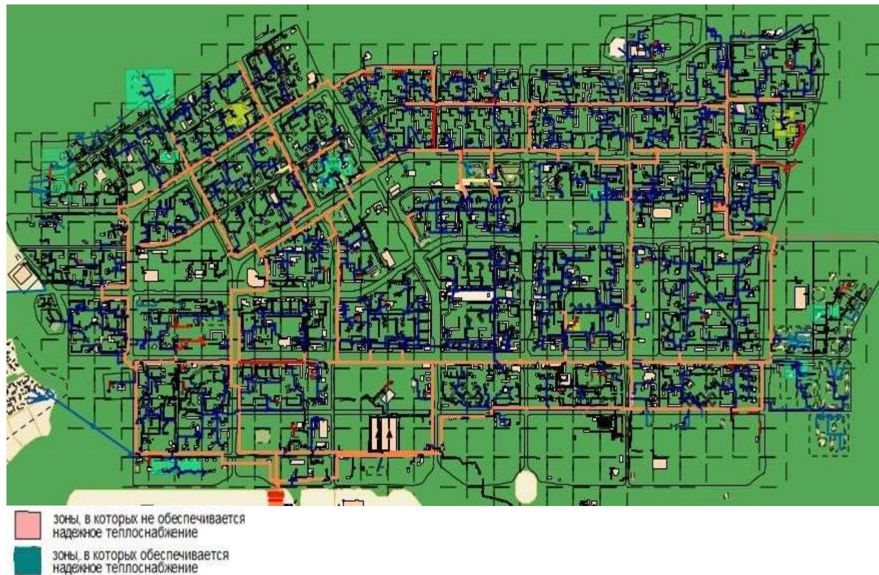
Рис. 9.3 Карта-схема тепловых сетей и зон ненормативной надежности северо-восточной части города.
